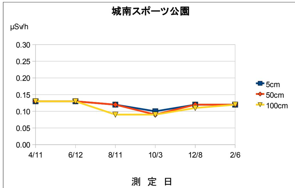
測定は、NaIシンチレーション式サーベイメータ（日立アロカ社製：TGS-172B）を使用しています。
