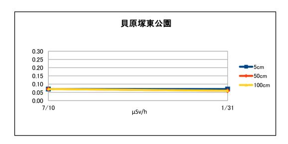
測定は、NaIシンチレーション式サーベイメータ(日立製作所社製:TCS-172B)を使用しています。
