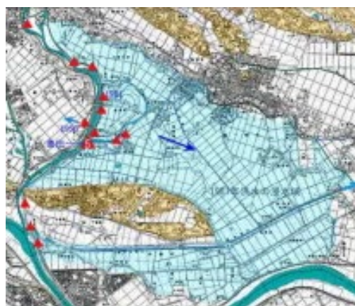
□小貝川の堤防決壊箇所
